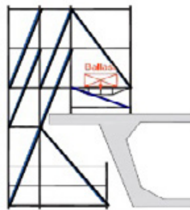
Figuur 29a: Ballast op 1 plaats
